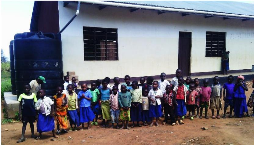
Der erste Kindergarten von Mllenga. Da der nächste Bach 6 km von Mlenga entfernt ist, wird das auf das Dach auftreffende Regenwasser über die Dachrinnen und die Fallrohre in die Wassertanks an der Seite geleitet und dort gespeichert.
